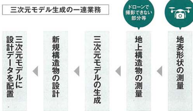
道路擁壁の建設業務で点群データをもとに三次元モデルを生成。設計したものの設置や活用をより明確にシミュレーションすることが可能になる。
