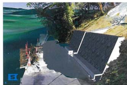
道路擁壁の建設業務で点群データをもとに三次元モデルを生成。設計したものの設置や活用をより明確にシミュレーションすることが可能になる。
